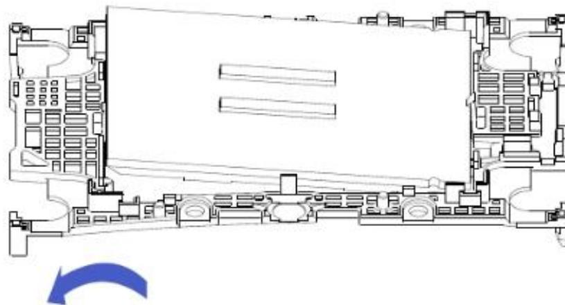
1-3. 松开夹持片，使夹持片另一端卡扣住 CPU 凹槽。
